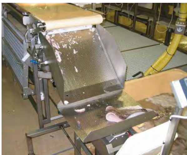
Mynd 2. Endinn á forsnyrtibandi, vogin er þar sem flakið er. Voginn vigtar 5-6 flök í hverjum skammti og hellir flökunum í keríð.
